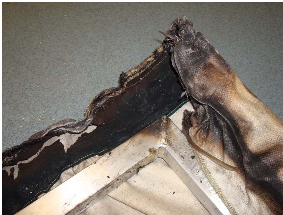
Detailaufnahme vom Rauchverschluss
