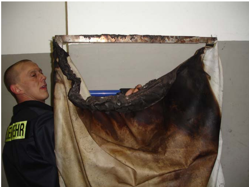
Der Klettverschluss hat allem Anschein nach der Belastung nicht mehr standgehalten. (Foto: Einsatzdokumentation FF Bad Harzburg).
