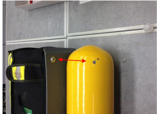
Nachdem die Fehlersuche den Anfangsverdacht zeigte wurde mit ein paar Versuchen der Schädigungshergang reproduziert. Es scheint erwiesen dass ein einseitiges Abstellen der Tasche und eine dadurch erzeugte Biegung der Rutschfläche punktuellen Kontakt zwischen Flasche und Halteschraube zulässt.
