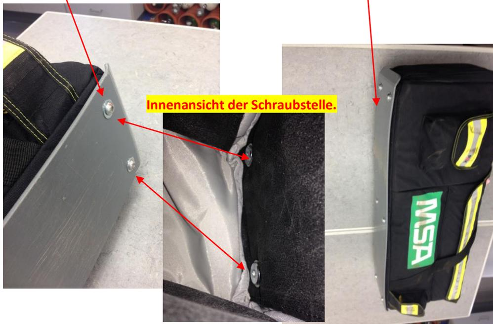
Durch ausmessen und positionieren scheint es erwiesen dass die Haltemutter der Rutschfläche für die Beschädigung verantwortlich ist.
