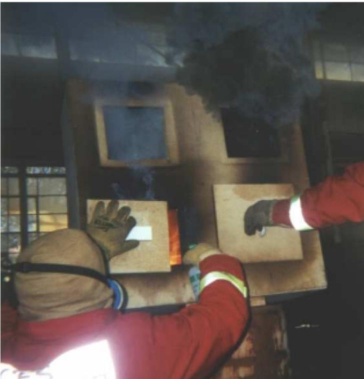
Auf diesem Foto sind in der Öffnung oben links deutlich die leichteren Pyrolyseprodukte zu erkennen (zwischen den einzelnen Räumen besteht keine Verbindung). Die Öffnung oben rechts steht in Verbindung mit dem Brand unten; der dunkle Rauch weist auf eine fette (Sauerstoffkontrollierte) Verbrennung hin.
