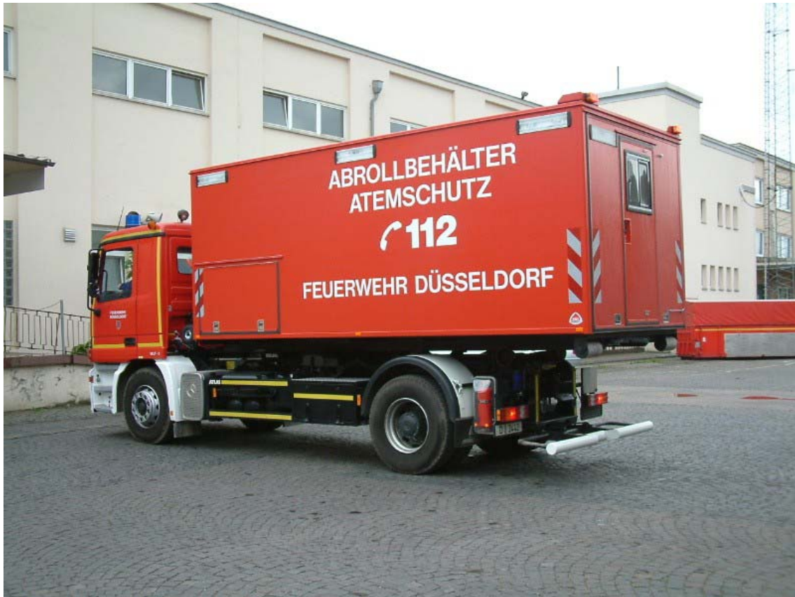
Bild 2: Der Nachschub mit Atemschutzgeräten kann beispielsweise mit Gerätewagen-Atemschutz oder Wechselladerfahrzeug mit Abrollbehälter „Atemschutz“ sichergestellt werden. Für eine reibungsfreie Atemschutz-Logistik sollen möglichst komplette Atemschutzgeräte einschließlich Atemanschlüssen an Einsatzstellen gebracht werden. (Foto: Truckenmüller)
